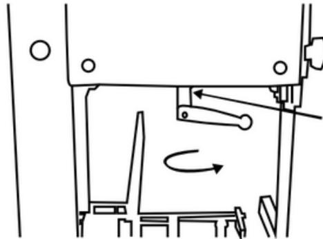
Este equipo incorpora un sistema de tensión total (automático), el cual permite que la cinta banda llegue a su tensión adecuada y se alinee en las poleas y guías. Este sistema está diseñado pensando para sacar el máximo de provecho de sus cortes de forma fácil y sin esfuerzos alargando la vida de sus cintas bandas. Colocar grasa grado alimenticio en rosca del tornillo incluida en el Equipo.
