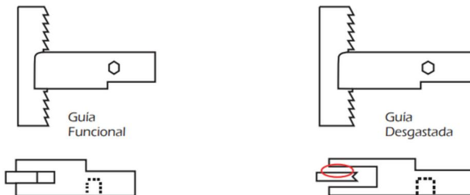
Las guías tungsteno sirven para controlar los movimientos de la cinta banda que se presentan al momento de realizar los cortes, estas guías tienen un desgaste normal y el momento de reemplazarlas se muestra continuación en las siguientes figuras:
