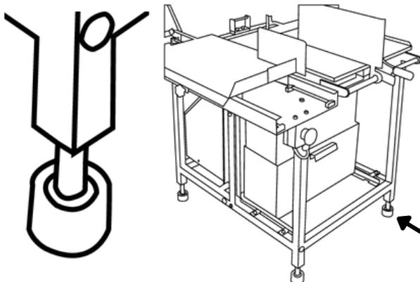
Se recomienda colocar la Sierra en un lugar con piso plano, utilice las patas niveladoras hasta con 3 pulgadas de ajuste para asegurar que la sierra quede en una posición firme y segura.
