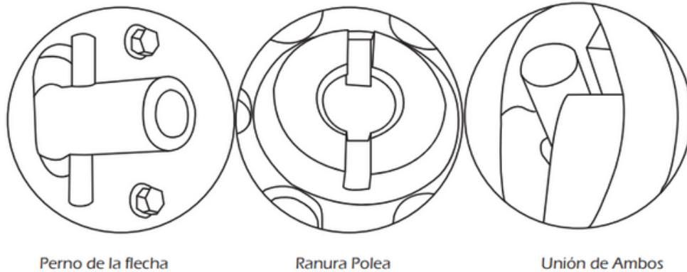
Una vez colocadas las poleas se aseguran con el candado como se muestra en la siguientes figuras, esto para evitar que las poleas se salgan de la flechas al momento de estar en funcionamiento. Esta operación se realiza sin tensión en la cinta.
