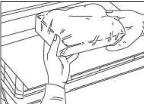
Estire la película de los lados y doble lo que resta de película debajo del paquete. Coloque el paquete rápidamente en el plato para sellar la parte inferior. Si es necesario ajuste la temperatura.
