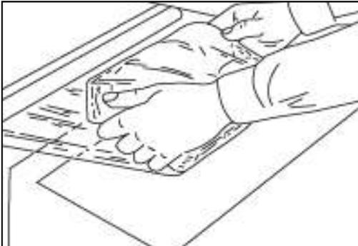
Tome el paquete de los lados, jálelo de nuevo sobre la varilla de corte y súbalo hacia la varilla para cortar la película.
