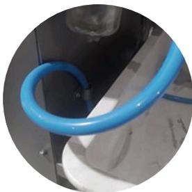
Siempre guarde el extremo de la manguera de vacío en su posición, **IMPORTANTE** verifique que esta no interfiera con el giro del tanque
